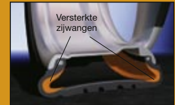
SSR banden: er kan nog 80 km mee worden gereden met een snelheid van maximaal 80 km/u.
