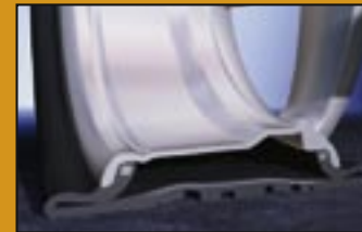
Spanningsverlies bij een gewone band: de band wordt al gauw stukgereden.
